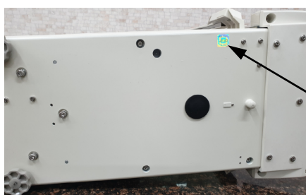
Рисунок 2 – Схема пломбирования весов от несанкционированного доступа
